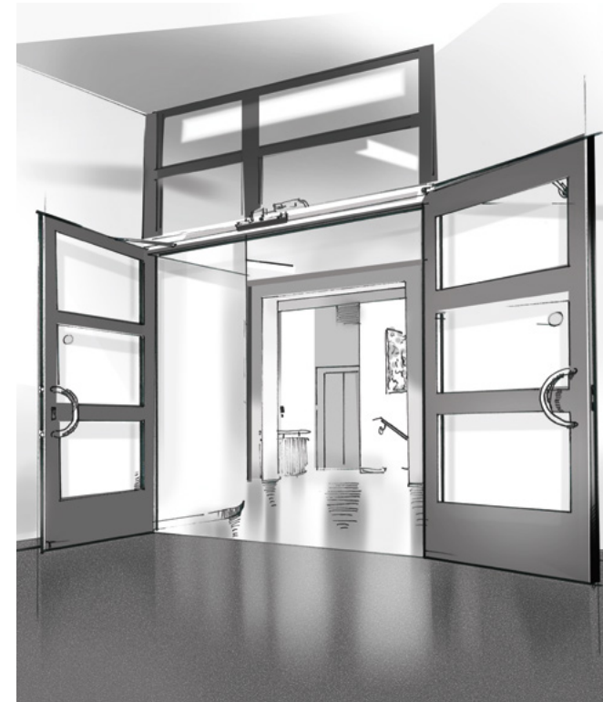
Beispielhafter Aufbau einer Brandschutztür mit Feststellanlage.
