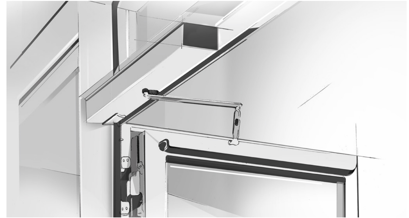
Beispielhafter elektromotorischer Antrieb mit Sensorleisten.
